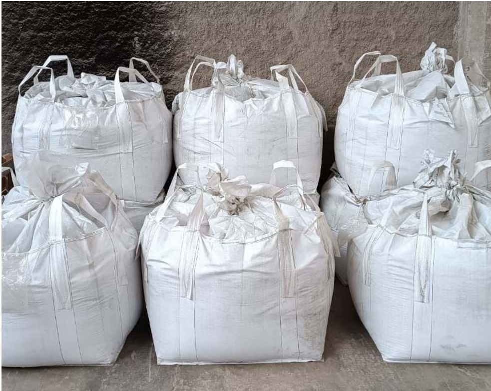
Foto 1. Shotcrete seco embolsado en presentación de 01 tonelada.
